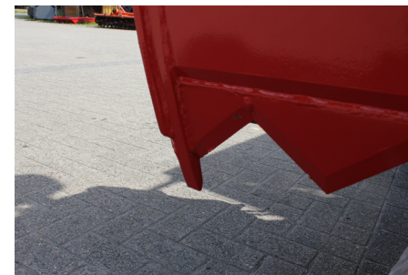
Eckzähne verhindern Beschädigung der Messer
