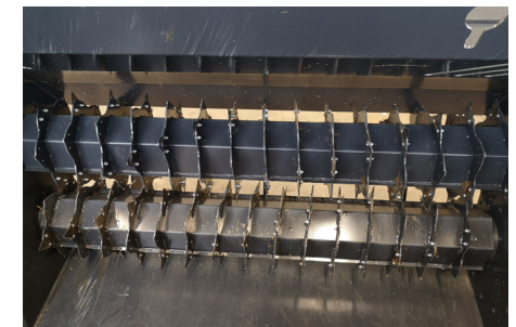
2 hydr. angetriebene Auflösewalzen mit 1/2 Satz Auflösemessern
