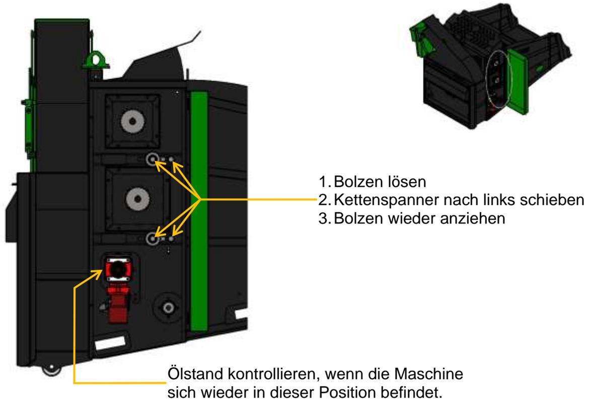
Den Ölstand des Zahnradkastens (Schauglas) monatlich kontrollieren. Dazu die Maschine nach hinten kippen, sodass sich das Gebläse in senkrechter Position befindet. Dieses Öl nach den ersten 50 Betriebsstunden austauschen. Anschließend jeweils nach 500 Stunden austauschen.
